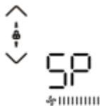
**Lorsque le climatiseur est éteint (OFF)**, dans la fonction de requête de température, appuyer sur «  $\wedge$  » ou «  $\vee$  » pour sélectionner SP, puis appuyer ensuite sur le bouton « Confirm » pour régler la valeur de pression statique.
